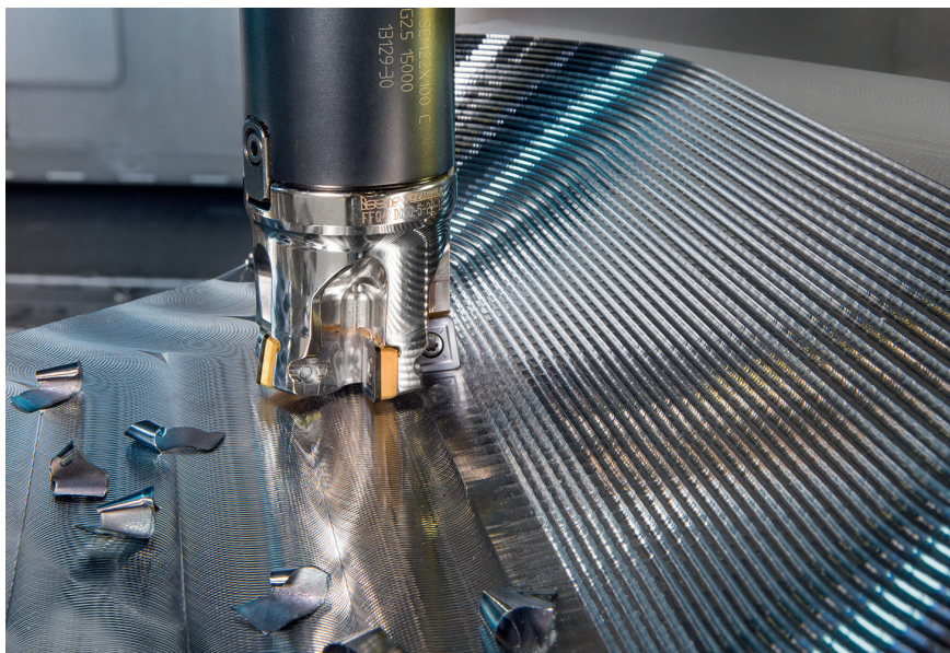
1 Mill 4 Feed ist ein Hochvorschub-FräSSystem, das seine Stärken vor allem beim Plan- und Konturfräsen ausspielt (© Iscar)
